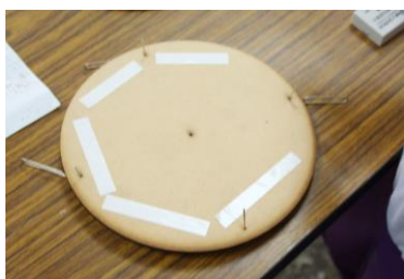
圖、虎鉗將迴紋針剪出小鐵棒，插入四個定位點，再用快乾膠將木板黏住，尖嘴鉗夾出小鐵棒
