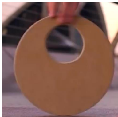
圖二、跟著鄭大師玩科學網站上的影片，挖洞的木板旋轉後洞會移動到下方
